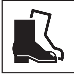
Работать в защитной обуви
