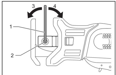
► 1. Hex wrench 2. Bolt 3. Loosen 4. Tighten
