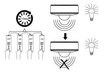
OFF / Wyl/ Aus / Выкл / Oprit / Apagado / Desligado / Kapali ON / Wł / Ein / Bкл / Pornit / Encendido / Ligados / Açık
