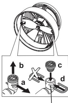
Uフックを引き出し (a)、ノズルを取り外し (b) た後
