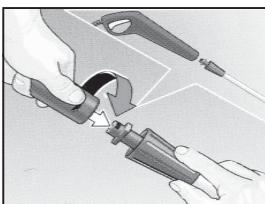
パイプをトリガーガン先端に押し込み、回転させて固定してください。
