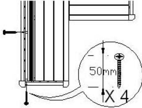
SCREW FROM THE OUTSIDE FACE OF PANEL (B) INTO THE END BRACE OF THE SEAT BACK
